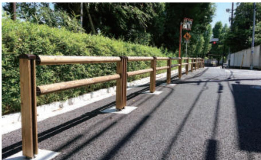
木材と鋼材を併用した高耐久性の横断抑止柵
