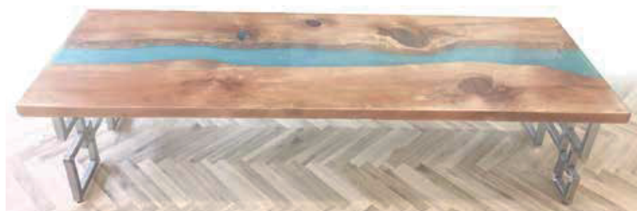
不整形な多摩産材を樹脂成形した大テーブル
